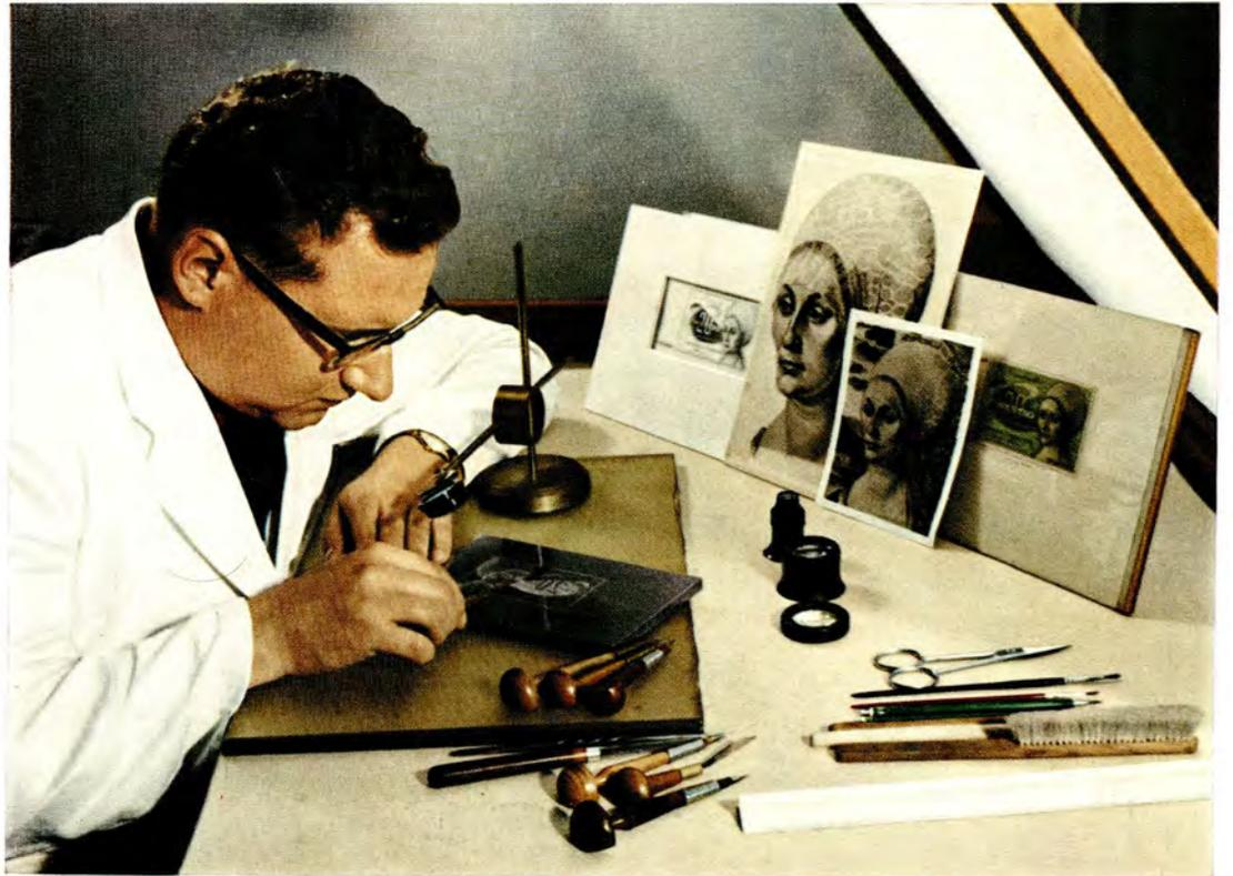
Bild 1 Mechanische Gravur des Schutzlinienwerks auf einer modernen Guillochiermaschine
