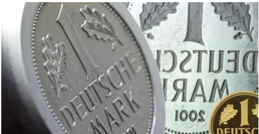
Patrize, Prägestempel und Münze der 1 DM-Goldmünze von 2001, Münzstätte Hamburg. Die Technik im Umsenkverfahren mittels einer Patrize schnell und effizient Prägeeisen herzustellen ist in der modernen Münzprägung ein Standardverfahren.
